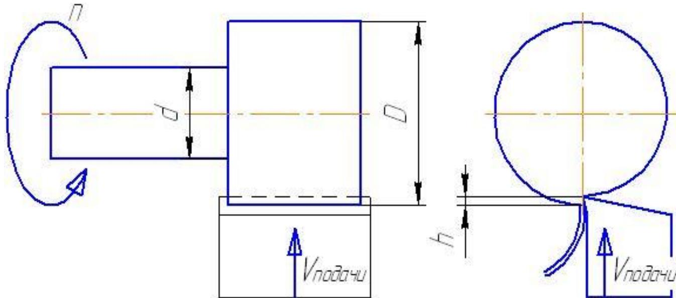
Начальный диаметр обрабатываемого участка заготовки составляет 50 мм. Скорость подачи в процессе обработки постоянна.
